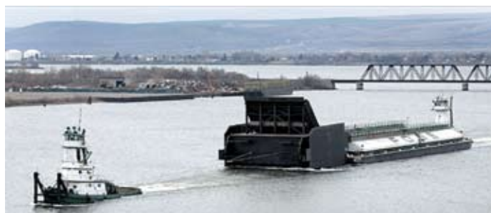
Два буксира ведут по р. Снейк (приток р. Колумбия) новый плавучий водосброс массой 800 т для ската молоди лососей.
